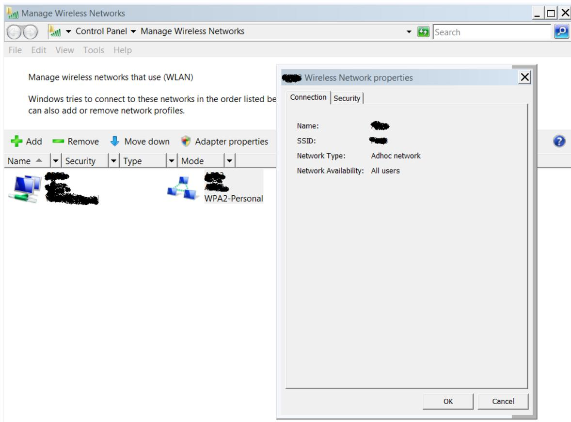
Einrichtung einer WLAN Verbindung auf dem zweiten Gerat zur Verbindung mit dem Ad Hoc Netzwerk.
