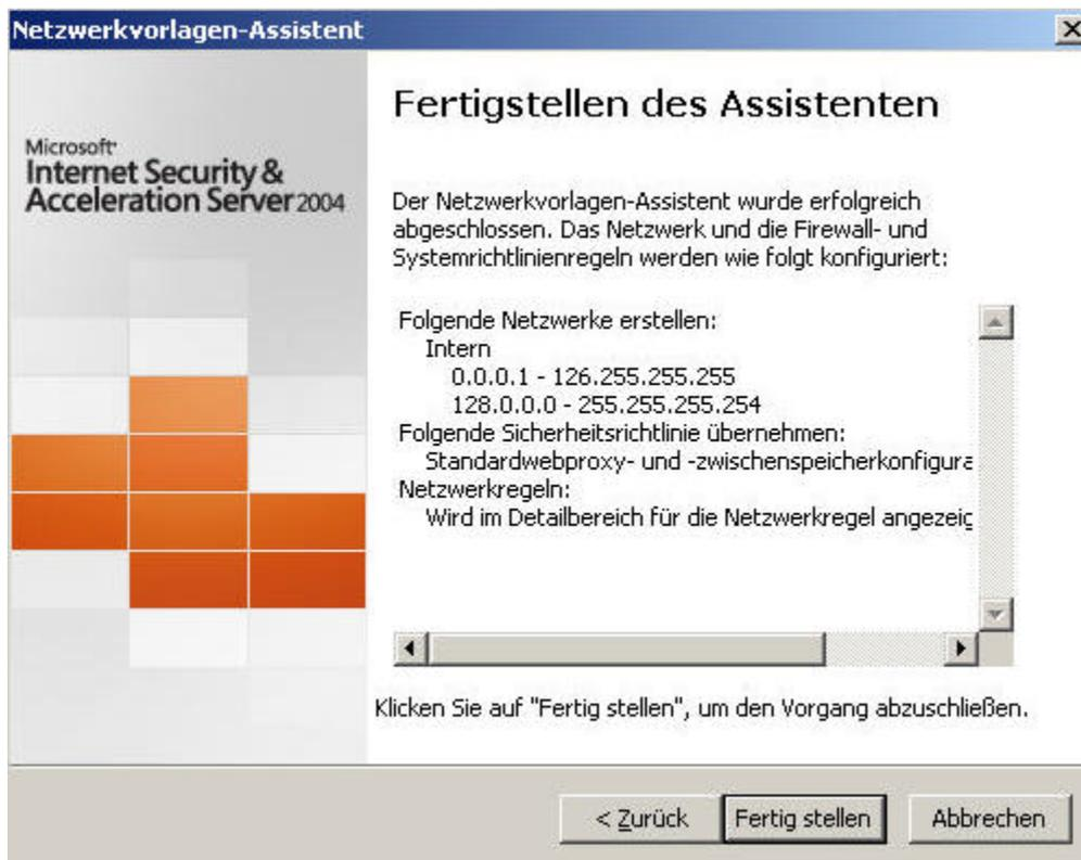
Nach erfolgreicher Konfiguration der neuen Netzwerkvorlage steht Ihnen jetzt die richtige Konfiguration für ISA Server 2004 als Proxy-Server zur Verfügung.
