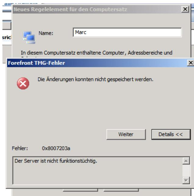
Das bedeutet, dass wenn die lokale AD-LDS Instanz nicht erreichbar ist, kann die Konfiguration auch nicht gespeichert werden!
